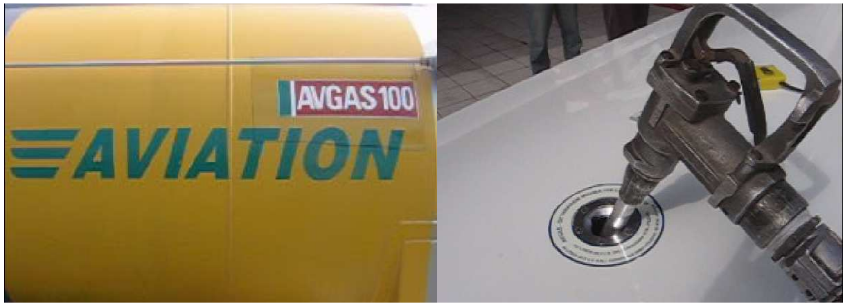
Fig.2 Bico da mangueira de AVGAS e bocal de abastecimento
