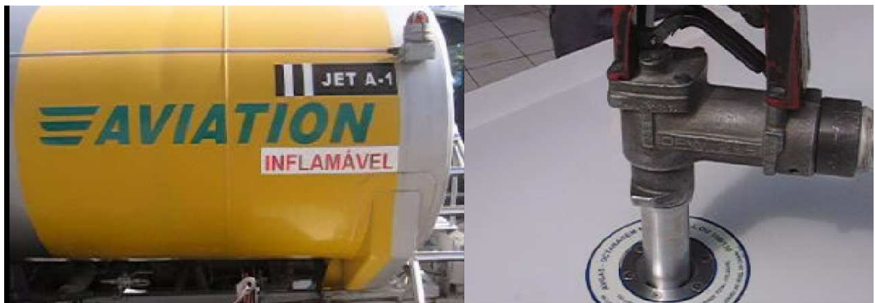
Fig.1 Bico da mangueira de JET A-1 e bocal de abastecimento
